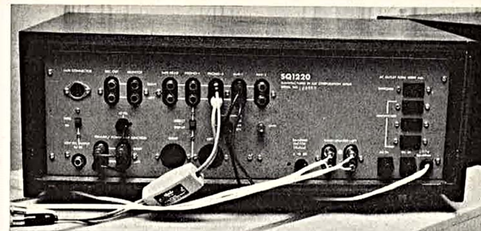
Fig 4. Bakre panelen på förstärkaren. Längst ned tv utgången för »3 D-kanalen» och över den omkopplaren till do, bredvid anslutningarna som förenar/avskiljer förstärkaren från effekt delen. Över de två urtagen för extra transformatorer syns omkopplaren för dessa. På vänstersidan finns också nivåreglaget för slutsteget. På höger sida sitter nertill, bredvid högtalaranslutningarna, omkopplaren för dämpfaktorval. Nätdelens reglage längst t h. (Foto RT)
