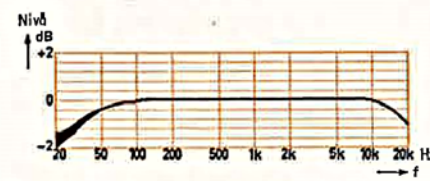
Fig 13. Frekvenskurva vid 1 W i 8 ohms res.last, vänster kanal hos Lux-förstärkaren.
