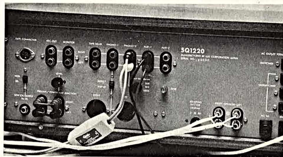
Fig 5. Närbild av bakpanelen med de niopoliga transformatoruttagen m fl detaljer. (Foto RT)
